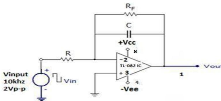
FIG: INTEGRATOR CIRCUIT
