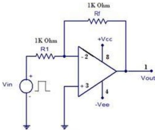
FIG INVERTING AMPLIFIER
