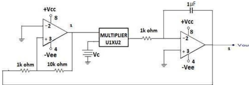
FIG: VOLTAGE CONTROL OSCILLATOR
